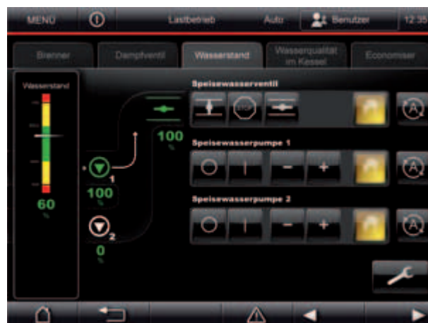
Znázornenie nastavovacej úrovne regulačný ventil napájacej vody
